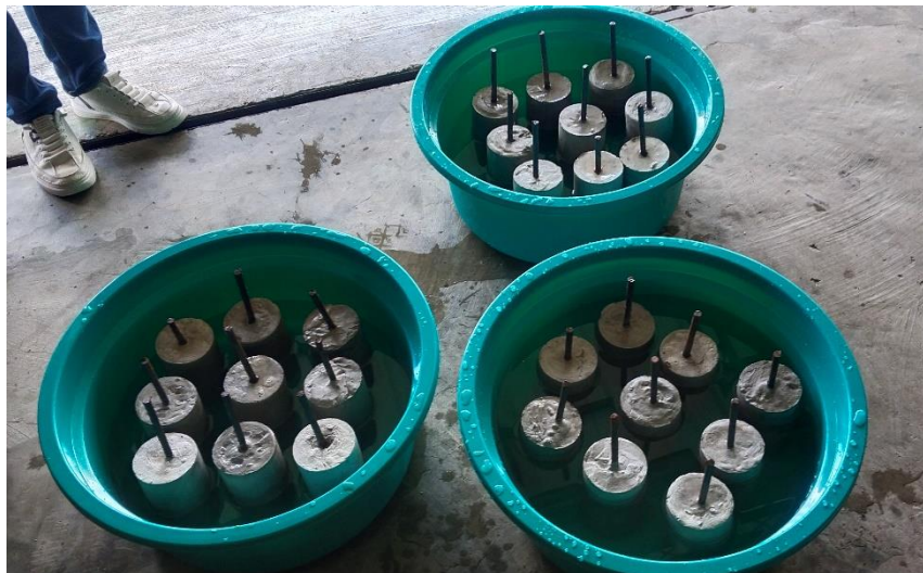
Gambar 2. Perendaman spesimen pada wadah yang berisi air laut buatan
