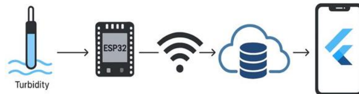
Gambar 1. Arsitektur Sistem Monitoring Kualitas Air Laut Berbasis IoT dan Naive Bayes
